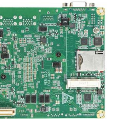
EAI-3501是一款基于低功耗RK3588处理器开发的3.5英寸ARM工业主板，尺寸小巧，全国产方案，支持AI推理运算。可根据不同应用场景，可灵活选配I/O接口，满足客户多样化生产应用需求，如医疗检测，机器视觉，工业控制，智能机器人等场景。
