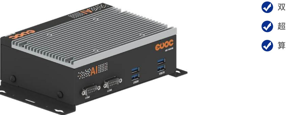
搭载Rockchip RK3576处理器，采用4核Cortex-A72与4核Cortex-A53架构，内置NPU提供6 TOPS INT8算力，能够高效进行AI计算加速。支持通过PCIe 2.1×1通道连接M.2 2280规格的NVMe固态硬盘，并保留MicroSD卡槽以扩展存储。
