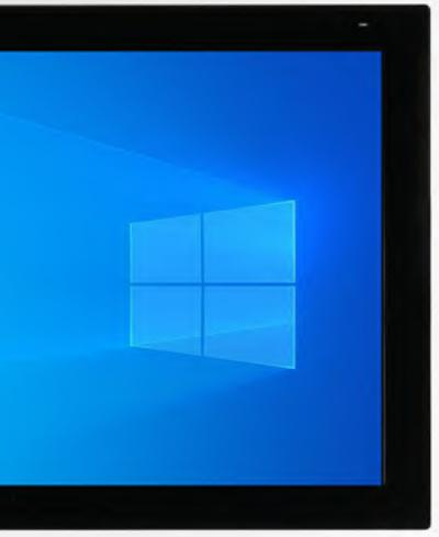
P19C是一款基于低功耗RK3576处理器开发的19"方屏ARM工业平板一体电脑,支持AI推理运算。整机前面板支持IP65防护,内部采用无风扇模块化设计,根据不同应用场景,可灵活更换I/O接口和触摸屏类型,满足客户多样化生产应用需求。
