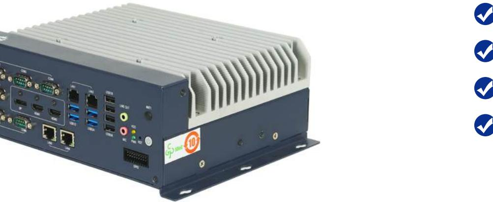
M60D-FT是基于飞腾D3000M处理器开发的一款无风扇嵌入式整机，机壳采用铝合金+钣金组成。外形尺寸小巧，结构紧凑、模块化程度高，全密封、无风扇设计，外壳兼作散热用。具有优良的密封防尘、散热与抗振性能。可以满足污染大，灰尘多，电磁干扰严重等恶劣环境的使用。广泛应用于高速公路车道控制、机械检测设备、智慧交通、工业自动化控制、视觉检测、物流分拣等各种嵌入式应用领域。
