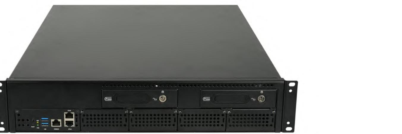
NPC-8208B-ZX是一款标准2U上架国产化网络安全应用产品，基于国产ZX KX-6000系列处理器（可选4核或者8核）开发，支持4个DDR4内存，整机内存容量可达64G，通过配置网络模块，最大可支持34个千兆网口。
