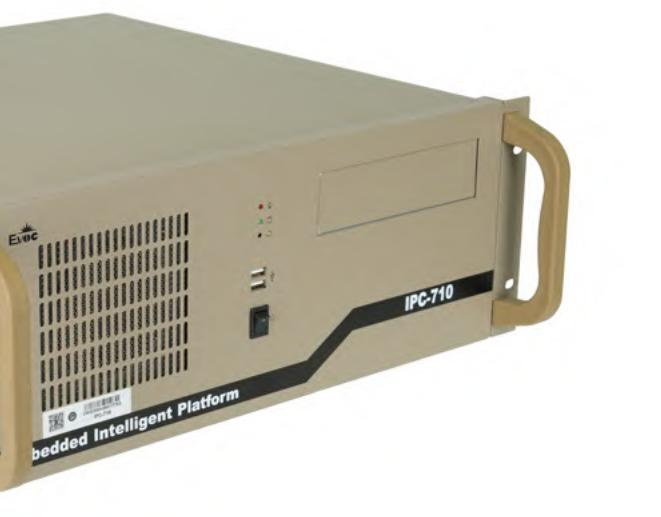
IPC-710是一款4U上架机箱，可以兼容公司FSC、EPI、EPE、ECS、EC9、EC0等各类全系列全长卡和工业母板，内置高速进风风扇；具有良好的散热、抗振、EMC性能。产品结构合理，设计先进，前面板采用钣金造型，主机体为优质钢板成型，双压条结构，可有效固定主板重心位置。
