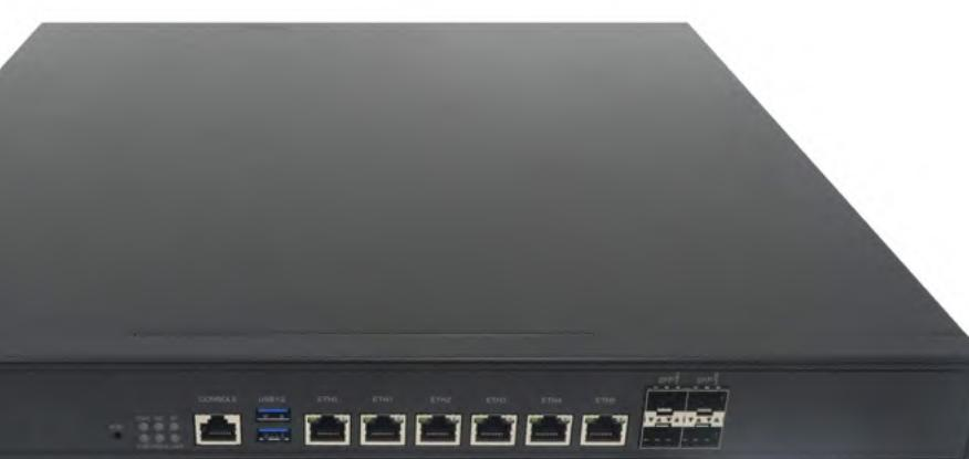
NPC-5115B-ZX是一款基于兆芯C4000开发的标准上架1U整机。整机采用钣金材质，具有良好散热、抗振性能，提供10个千兆网口，支持1个ENS网卡扩展槽，产品广泛应用于防火墙、入侵检测。入侵防御，防毒墙、VPN等场景。
