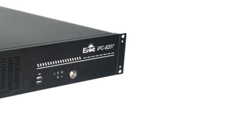
IPC-8207是一款2U19寸飞腾D2000国产化标准上架式机箱，兼容小1U电源、冗余电源安装；前面板2个USB接口、电源开关、状态指示灯、复位按钮；前置可拆卸防尘过滤网、更换方便；机箱前面板进风，后面板出风，具有良好的散热性能。可广泛应用于工业控制、工业自动化、智能交通、视频监控等领域。
