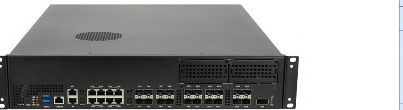
NPC-5219-KP是一款基于国产鲲鹏920系列核心板设计的标准2U上架式整机。整机板载8个千兆电口、20个万兆光口和1个100G光口，支持4个DDR4 RDIMM内存插槽，单槽支持最大32G内存容量，支持银河麒麟V10 SP1及以上桌面版操作系统和欧拉22.03版本操作系统。
