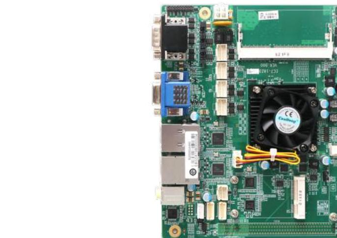
EC7-1501-ZX一款兆芯KX6000系列Mini-TX主板,高性价比功耗板载CPU,DDR4内存插槽,最大可支持32GB内存容量,支持多显示接口,多网口,多串口,提供一个PCI-E16扩展接口(实际速度X8)、一个Mini PCIe接口(支持扩展4G、5G及WiFi模块)、一个SIM卡插槽,一个M.2接口,广泛应用于银行、税务、自助等行业。
