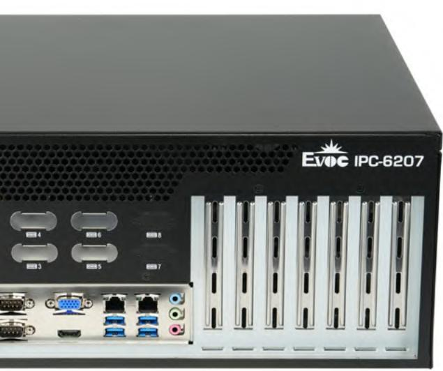
IPC-6207是一款七槽紧凑型壁挂整机，可搭配EC0、ECS等系列主板。在紧凑体积下仍拥有良好扩展性能，支持7个扩展槽位；操作方便，整机所有的I/O接口均位于同一面；具备紧凑尺寸、高性能、丰富I/O的接口特性。
