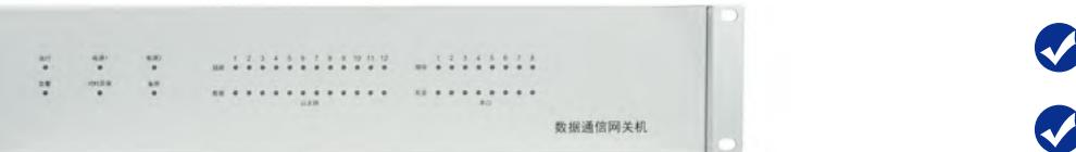
SPC-8272-FT 是一款基于国产处理器飞腾 D2000 开发的标准 2U 上架电力专用机。整机最多可选 24 个网口，支持 6~12 个串口可选，满足客户多样化应用需求，如二次设备检测、智能网关、数据采集、远动终端等场景。
