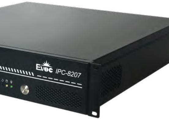
IPC-8207是一款2U19寸3400系列海光国产化标准上架式机箱，兼容小1U电源、冗余电源安装；前面板2个USB接口、电源开关、状态指示灯、复位按钮；前置可拆卸防尘过滤网、更换方便；机箱前面板进风，后面板出风，具有良好的散热性能。可广泛应用于工业控制、工业自动化、智能交通、视频监控等领域。
