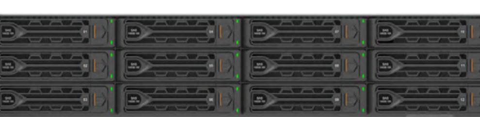
EVOC Adam Server R322H6是亿万克基于海光3号平台面向政企、金融、电信、交通铁路、运营商等关键领域推出的一款2U双路企业级服务器,支持2颗Hygon 5300系列处理器,双路最高32核,处理器集成安全管理模块,支持SM2/3/4等国密算法,无ME后门,可实现基于芯片级别的安全保护,保证设备的安全及稳定运行。提供16个DDR4内存插槽,支持内存加密功能,确保信息无泄漏风险。前置12个3.5英寸热插拔硬盘盘位,可选多种硬盘类型。板载双口千兆网络接口,6个PCIe扩展插槽满足各类扩展需求,具备安全性、可靠性、稳定性、高扩展性等特点,可承载现有x86应用,适用于各领域。
