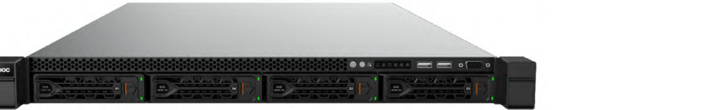
EVOC Adam Server R311H6是亿万克基于海光平台面向政企、金融、电信、交通铁路等国产化需求领域推出的一款1U单路入门级企业服务器，支持1颗Hygon 3250/3350处理器，最高8核，处理器集成安全管理模块，支持SM2/3/4等国密算法，无ME后门，可实现基于芯片级别的安全保护，保证设备的安全及稳定运行。提供4个DDR4内存插槽，支持内存加密功能，确保信息无泄漏风险。前置4个3.5英寸热插拔硬盘盘位，可选多种硬盘类型。板载双口千兆网络接口，最大2个PCIe扩展插槽满足各类扩展需求，具备安全性、可靠性、稳定性、高扩展性等特点，可承载现有x86应用，适用于各类应用。
