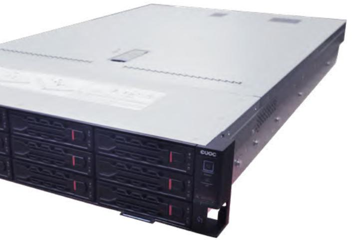
EVOC Adam Server R321H6+是亿万克基于海光3号平台面向政企、金融、电信、交通铁路等国产化需求领域推出的一款2U单路企业级服务器，支持1颗Hygon 7300/5300系列处理器，最高32核，处理器集成安全管理模块，支持SM2/3/4等国密算法，无ME后门，可实现基于芯片级别的安全保护，保证设备的安全及稳定运行。提供16个DDR4内存插槽，支持内存加密功能，确保信息无泄漏风险。前置12个3.5英寸热插拔硬盘仓位，可选多种硬盘类型。板载双口千兆网络接口，6个PCIe扩展插槽满足各类扩展需求，具备安全性、可靠性、稳定性、高扩展性等特点，可承载现有x86应用，适用于各领域。
