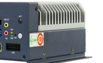
M60B-HG是基于海光3350处理器开发的一款AI无风扇工业控制器系列无风扇嵌入式整机，机壳采用铝合金+钣金组成。外形尺寸小巧，结构紧凑、模块化程度高，全密封、无风扇设计，外壳兼作散热用。具有优良的密封防尘、散热与抗振性能。可以满足污染大，灰尘多，电磁干扰严重等恶劣环境的使用。广泛应用于高速公路车道控制、机械检测设备、智慧交通、工业自动化控制、视觉检测、物流分拣等各种嵌入式应用领域。
