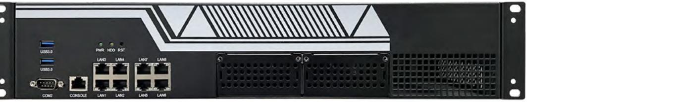
N35B-HG是一款标准2U上架国产化网络安全应用产品，基于海光3200/3300系列处理器（可选4核或者8核）开发，支持2根DDR4内存插槽，整机容量最大支持64G，板载8个千兆电口，支持2个ENS网络扩展模块，整机最大可实现24个千兆网口。
