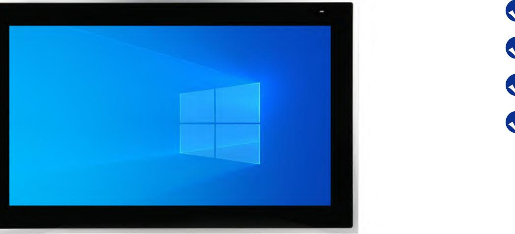
W23是一款23.5"宽屏工业平板一体电脑,前面板支持IP65防护等级,内部采用无风扇模块化设计,支持国产海光CPU,根据不同应用场景,可灵活更换I/O接口和触摸屏类型。
