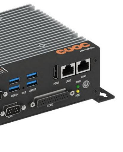
边缘计算盒子AIB-1008-ST是基于华为昇腾Atlas200 A2模组的采集分析一体化平台产品，具有硬件接口丰富、集成度高、小型化、易部署等特点，可满足多种工业场景的应用需求。
