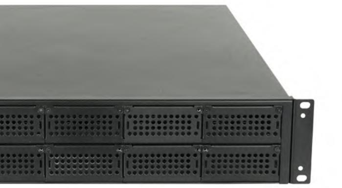
NPC-8208B-HG是一款标准2U上架国产化网络安全应用产品，基于国产海光3200系列处理器开发，支持4根DDR4内存插槽，整机容量可至128G，板载2个千兆网口，标配4个ENS网络模块（可选配8个ENS扩展位），整机最大可支持34个千兆网口（可选配16组bypass）。
