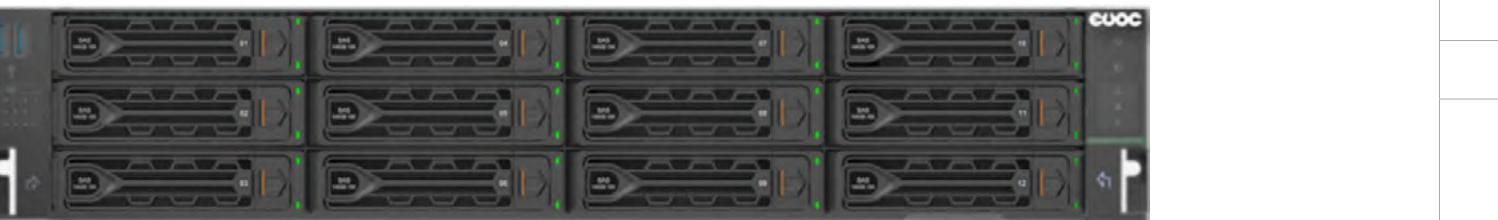
EVOC Adam Server R322H7+是亿万克基于海光平台面向政企、金融、电信、交通铁路、运营商等关键领域推出的一款2U双路企业级服务器,支持2颗Hygon 7400系列处理器,支持安全启动、安全内存加密和安全虚拟化加密等功能,最大支持24个DDR5内存插槽,支持10个PCIe 5.0槽位,内存和IO性能全面提升。采取自动化与统一化管理,简化数据中心运维,适用于计算集群部署、云计算、虚拟化部署、大数据分析等应用场景。
